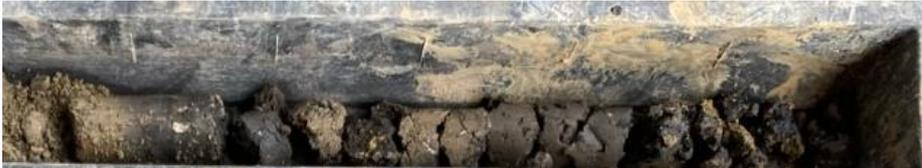
Abbildung 3: Unterboden aus RKS 23-1 (Tiefe 0.6 bis 1.0 m ab OK Terrain)
