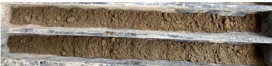
Abbildung 4: fluvioglaziale Sedimente aus RKS 23-1 (Tiefe 3.0 bis 5.0 m ab OK Terrain)
